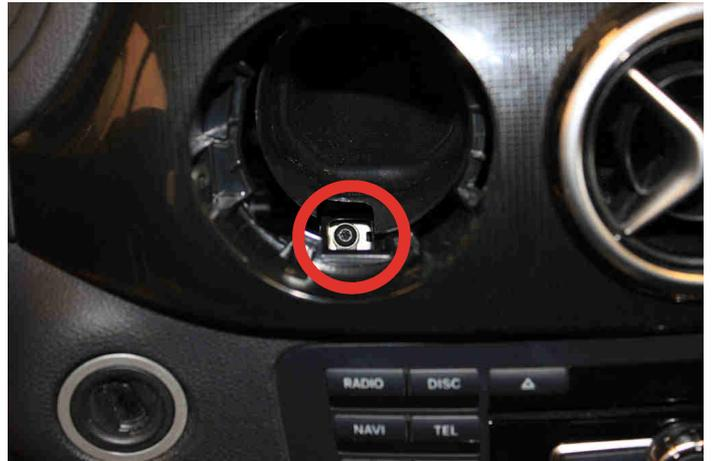
Greifen Sie unter die Verkleidung an das verbaute Radio und schieben es aus der Mittelkonsole heraus.
