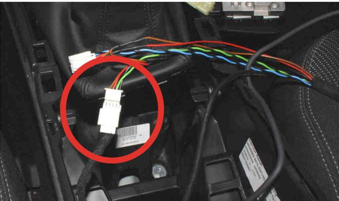
Im Anschluss montieren Sie die Kunststoffverkleidung wieder in der Armlehnenbox und befestigen diese mit den beiden Schrauben. Die beiden verlegten Leitungen liegen hierbei in der Öffnung, welche Sie ausgeschnitten haben.
