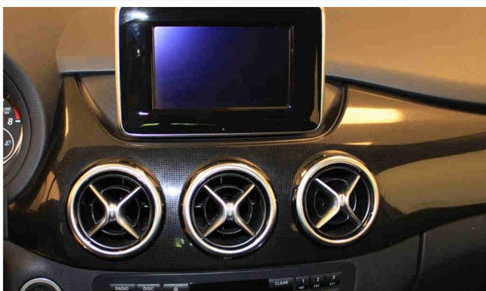
Im Folgenden müssen die linke und die rechte Lüftungsdüse entfernt werden.
