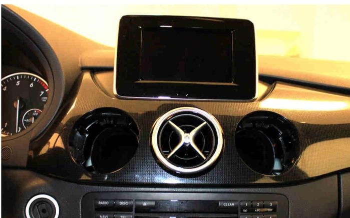
Lockern Sie die sichtbar gewordenen Schrauben in der Lüftungsdüsenöffnung mit einem Torx20 Schraubendreher.
