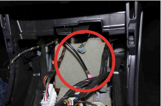
Das Ende mit dem **pinken Stecker**, als auch den aus dem Radio entfernten **grauen Stecker** verlegen Sie hinter der Verkleidung in die Öffnung unterhalb des Radiosystems.
