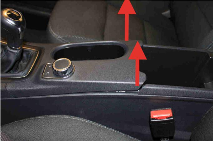
Öffnen Sie die Armlehnenbox und greifen mit beiden Händen links und rechts unter die Verkleidung des Mitteltunnels. Heben Sie die Verkleidung an, bis diese aus der Verriegelung rutscht. Sollte es zu schwer gehen, verwenden Sie vorsichtig einen Schraubendreher.
