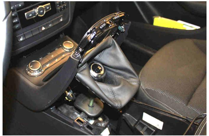
Stülpen Sie die Mittelkonsole über den Schaltsack und drücken von unten gegen die Rastnasen des Schaltsackrahmens, um diesen zu entfernen. Im Anschluss fädeln Sie diesen durch die Öffnung der Verkleidung.
