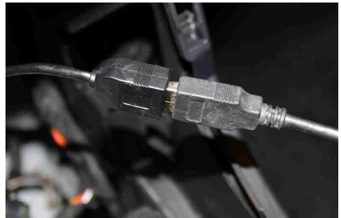
Sichern sie alle Kabel gegen versehentliches Herausrutschen, indem Sie sie mit einem Kabelbinder zusammenzurren und so für eine Zugentlastung sorgen (nebenstehendes Bild ist ein Beispiel).
