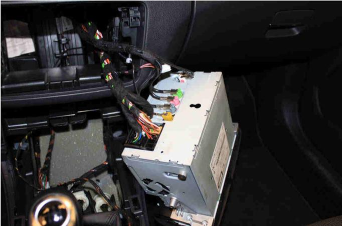
Legen Sie das Radiosystem rechts neben der Mittelkonsole ab.
