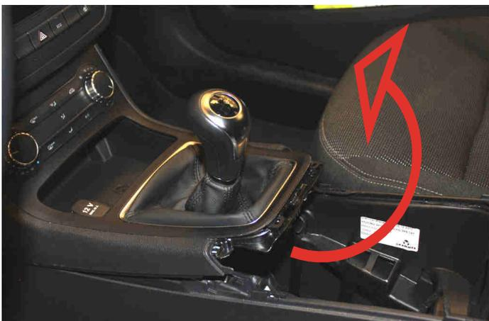
Ziehen Sie die Konsolenverkleidung hoch, bzw. von der Mittelkonsole weg und klippen diese aus (roter Pfeil).
