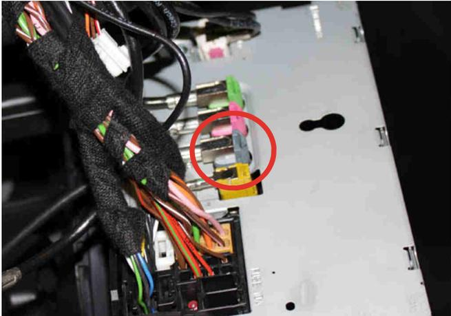
In den frei gewordenen Steckplatz des Radios stecken Sie den grauen Stecker des mitgelieferten LVDS-Kabel.
