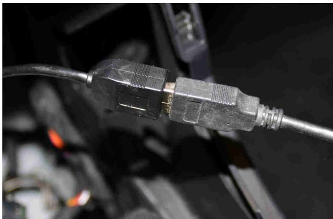
An den soeben angeschlossenen USB-Adapter schließen Sie den USB-Stecker der in der Mittelkonsole verlegten USB-Verlängerung an. Sichern Sie die Verbindung ggf. mit einem Klebeband.
