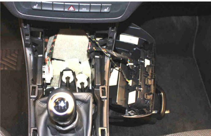
Die Lüftungsdüsen sind nur eingesteckt. Fahren Sie mit einem Montagekeil oder einem flachen Gegenstand zwischen Armaturenbrett und dem Rahmen und hebeln den gesamten Einsatz der Lüftungsdüse heraus.
