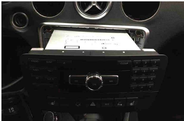
Ziehen Sie das verbaute Radio aus der Mittelkonsole heraus.
