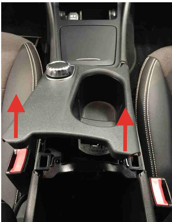
Öffnen Sie die Armlehnenbox und greifen mit beiden Händen von hinten unter die Verkleidung des Mitteltunnels. Heben Sie die Verkleidung an, bis diese aus der Verriegelung rutscht. Die Verkleidung ist an den vier Eckpunkten eingerastet.
