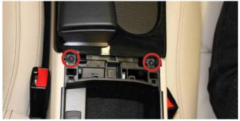
Befestigen Sie auch das hintere Ende der Mittelkonsole mit den Schrauben und setzen Sie die Blende wieder auf.
