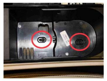
Öffnen Sie anschließend das Schiebefach, entnehmen Sie den eingelegten Gummiboden und entfernen Sie die beiden darunterliegenden TX20 Schrauben.
