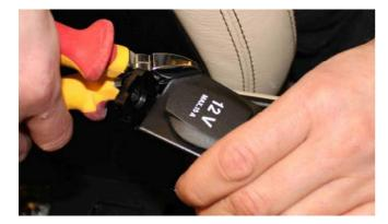
Entfernen Sie anschließend mit einem Seitenschneider die untere Ecke des Anschlussterminals wie dargestellt mit einer Kantenlänge von 1cm.
