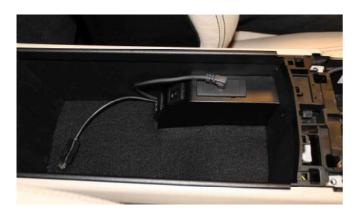
Fädeln Sie das mitgelieferte USB-Kabel und falls Ihr Fahrzeug über ein **Medien-interface** verfügt, auch das Audiokabel mit Audiobuchse von der Mittelkonsole in das Ablagefach. Das Audiokabel stecken Sie an den AUX-Adapter des Medieninterface.
