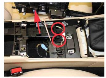
Hinter dem Kunststoffhalter befindet sich in der Trennwand zum großen Ablagefach eine Schraube TX20, die das Anschlussterminal im Ablagefach hält. Entfernen Sie diese Schraube.
