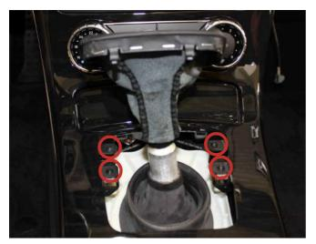
Drehen Sie die Schrauben in der Aussparung für den Schalthebel ein und setzen Sie den Balg wieder ein.
