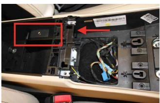
Entfernen Sie den Teppich im großen Ablagefach der Mittelkonsole, indem Sie diesen mit einem großen Schraubenzieher oder einem Montagekeil am vorderen Ende anheben und nach oben herausnehmen.
