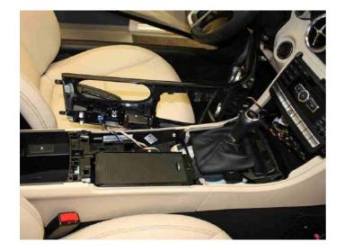
Fädeln Sie die Schaltmanschette durch die Aussparung der Mittelkonsole und legen Sie die Konsole vorsichtig auf den Fahrersitz. Achten Sie dabei unbedingt darauf keine der angeschlossenen Leitungen zu beschädigen.
