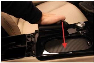
Schließen Sie die Mittelkonsole und rasten Sie diese durch einen kräftigen Druck auf die Schaltereinheit der Verdeckschalter ein.
