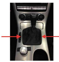
Lösen Sie die Schaltmanschette, indem Sie diese unten seitlich zusammendrücken und nach oben aus der Mittelkonsole lösen. Stülpen Sie diese anschließend nach oben über den Schaltknauf.
