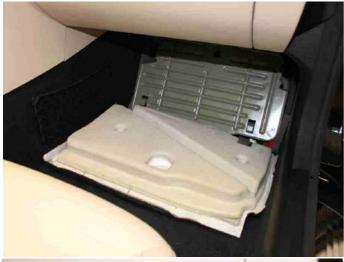
Entnehmen Sie die Fußmatte des Beifahrerfußraums. Greifen Sie anschließend mit einer Hand das obere Ende des Teppichs der Fußablage und klappen Sie diese in den Fußraum.
