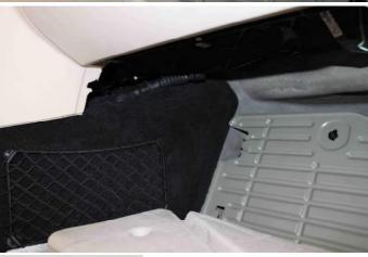
Entfernen Sie anschließend die Verkleidung, indem Sie diese nach unten in den Fußraum ziehen.
