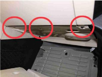
Drehen Sie die drei Torx TX20 Schrauben der oberen Fußraumverkleidung heraus.
