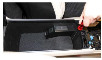
Lösen Sie anschließend das Anschlussterminal, indem Sie es kräftig entgegen der Fahrtrichtung schieben. Dies gelingt am besten, wenn Sie den Deckel des 12V Anschlusses öffnen und mit einem Finger in die Anschlussdose greifen und daran ziehen. Gleichzeitig können Sie wie dargestellt mit der anderen Hand am oberen Anschlusspannel schieben.
