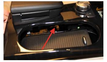
Bevor Sie das hintere Ende der Mittelkonsole einrasten, achten Sie unbedingt darauf, dass die Anschlussleitung der Verdeckschalter gerade durch die Aussparung des Kunststoffträgers läuft und nicht beim Aufstecken auf diesem zum liegen kommt.
