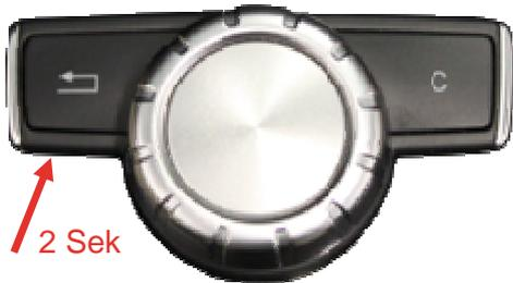
Zum Starten der luukbox® drücken Sie bei eingeschaltetem Radio für ca. 2 Sekunden auf den „Back“ Taster Ihrer Bedieneinheit.
